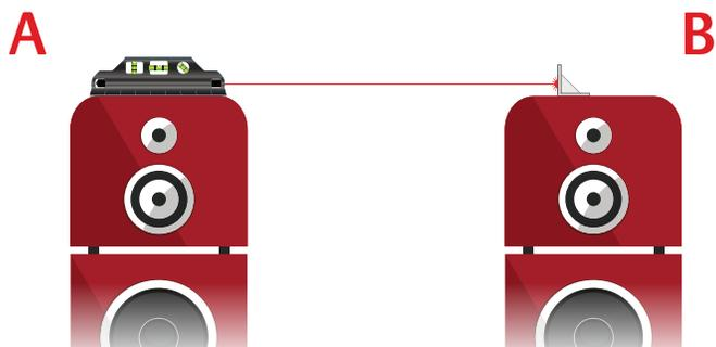
5. 使用调整工具转动尖部，直到激光束与扬声器 B 上的目标的十字线相吻合。
