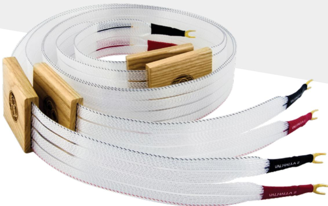
Valhalla 2 参考喇叭线由二十八根（分为四组，每组七根）导线组成。每根导线都由实芯 99.999999% 无氧铜制成，并电镀了 85 微米的银。每根导线都呈螺旋状缠绕双重单丝包布，然后在外部挤包一层精密的 FEP 护皮。此电缆的传输速度极快，达到光速的 97%。V2 以极宽的带宽信号和最小的相移诠释了顶尖科技。它具有无与伦比的瞬态响应和动态分辨率，可保留极具深度的音乐细节，让听者能够轻松感受复杂的音乐场景。V2 喇叭线端接 HOLO:PLUG® 镀金叉形接头或 Nordost 轻量化 Z 型插头。
