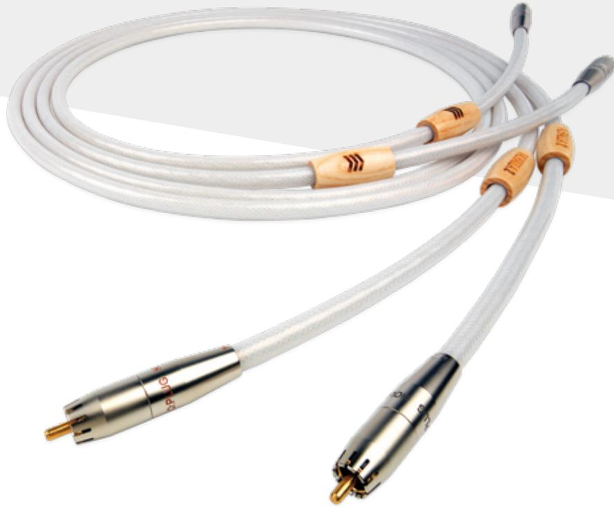
Valhalla 2 互连线由 10 根直径经过优化的实心 99.999999% 无氧铜制成的导线构成，每一根都电镀了 85 微米的银。表面经过高度抛光和处理，接着缠绕一层精密的双重单丝。然后在每根导线上挤包一根精密的 FEP 线管。接下来利用一种专有技术将十根 FEP 线管粘合在一起，形成一根管状互连线，并用两层银屏蔽层封住。V2 互连线自带 RCA 或 XLR HOLO:PLUG® 接头。
